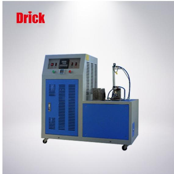
XCY 型低温脆性测定仪是测定硫化橡胶在规定条件下试样受冲击后呈现破坏时的最高温度。即为脆性温度。可以对非硬质塑料及其它材料在低温条件下的使用性能做比较性的鉴定。本仪器是根据国家标准设计的，各项技术指标符合 GB/T 15256-2008《硫化橡胶低温脆性的测定（多试样法）》等国家标准的要求。
